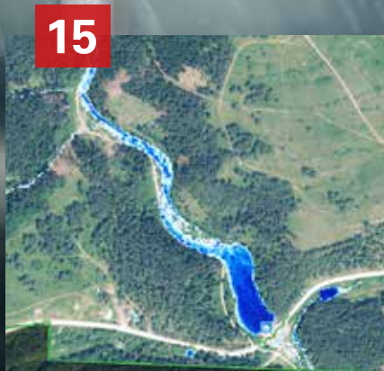
Einstau am Damm bei extrem ergiebigem Dauerregen nach 11 h, nach 15 h und nach 20 h.
