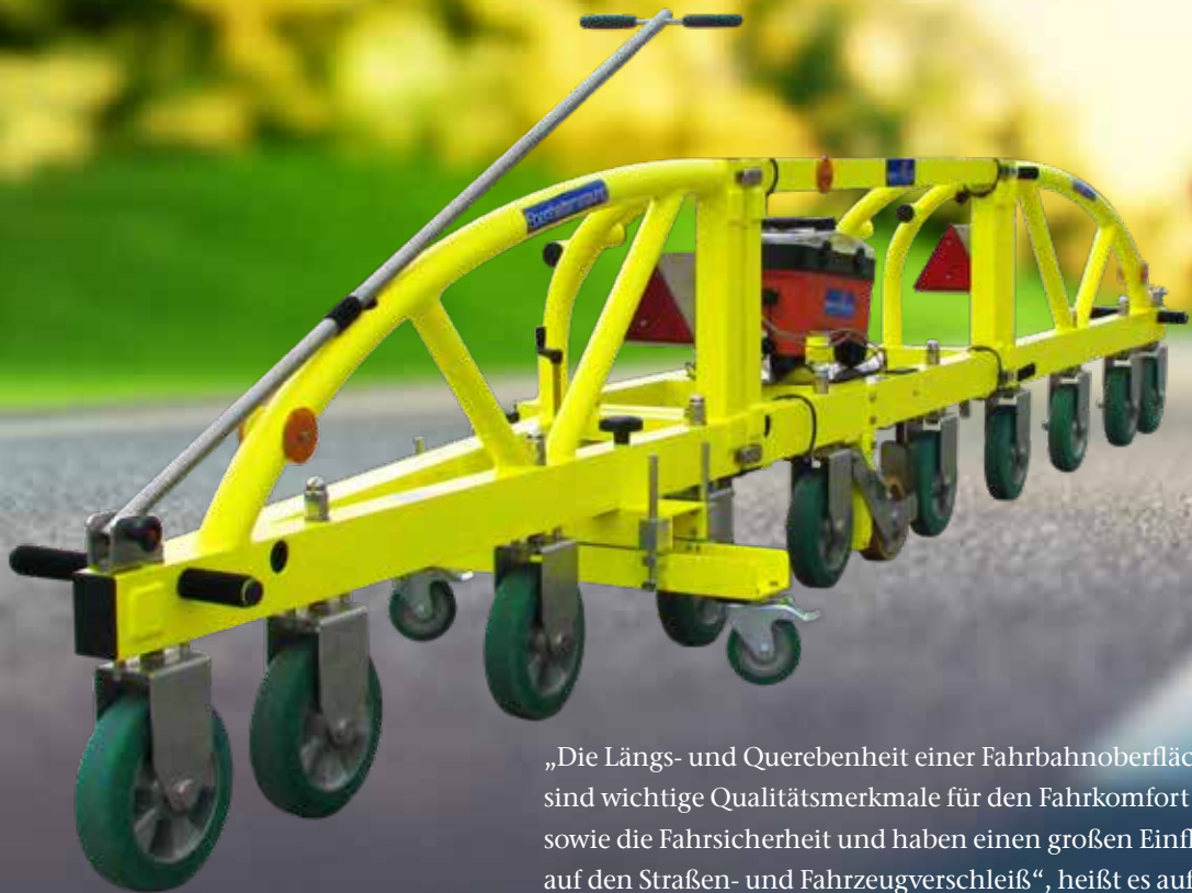
Der Planograph von Anix zur Ebenheitsmessung. (Darstellung im Layout verkleinert)
