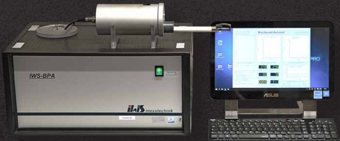
Zeitgenössischer Brechpunktautomat: Automatischer Apparat zur Bestimmung des Brechpunktes nach Fraaß an Bitumen gem. DIN EN 12593.
